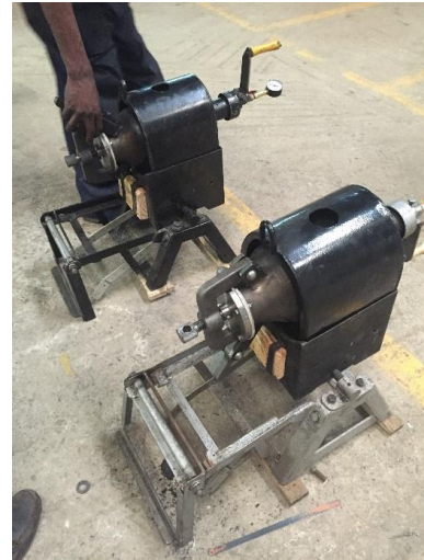
写真 2-10 (左). En9 を用いた鋳造法で製作した蓋の U 字部品。この部品の強度と精度がパフシリアル製造機の要である。(撮影：森元泰行)
