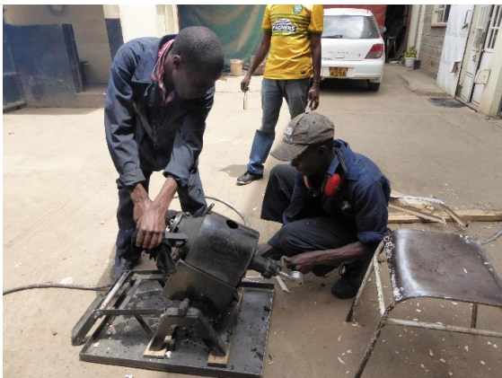
写真 2-8、2-9. DK engineering 社内のパフ加工機試作作業の様子。テストと改良を繰り返す。（撮影：森元泰行）
