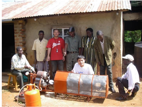
写真 2-1 (左) および写真 2-2 (右) ケニア製最初のポン菓子製造機の試作はケニア西部ソティックにあるカプロング工業専門学校に勤務していた石垣隊員 (溶接) によって、すべての材料を現地で調達する形で行なわれた。(撮影：森元泰行)
