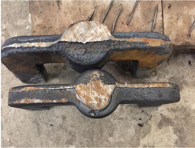
写真 2-10 (左). En9 を用いた鋳造法で製作した蓋の U 字部品。この部品の強度と精度がパフシリアル製造機の要である。(撮影：森元泰行)
