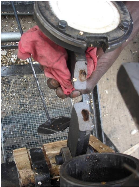
写真 2-7. 強度不足のため折れた部品。鑄造技術によって作製した部品中に大きな気泡があるのがわかる。 DK engineering 社製（撮影：森元泰行）
