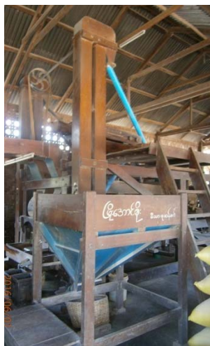
写真 2.4 Zee Pyu Pin 村精米業者の精米機 (ミャンマー製)
