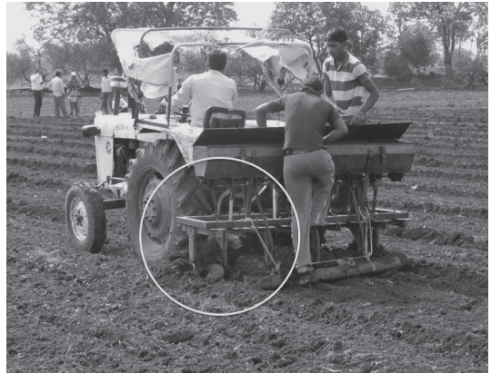
写真6 furrow opener の位置が深く、畦が掘れている (サガール、2015年6月29日)
