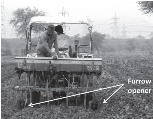
写真5 furrow opener の設定位置が浅く、畦溝が掘れていない (ホシャンガバード、2015年6月27日)
