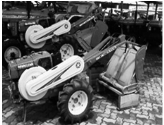
写真7 Noble Moters の耕うん機。エンジンは三菱製で、ボディーを含め組み立てはインド。
