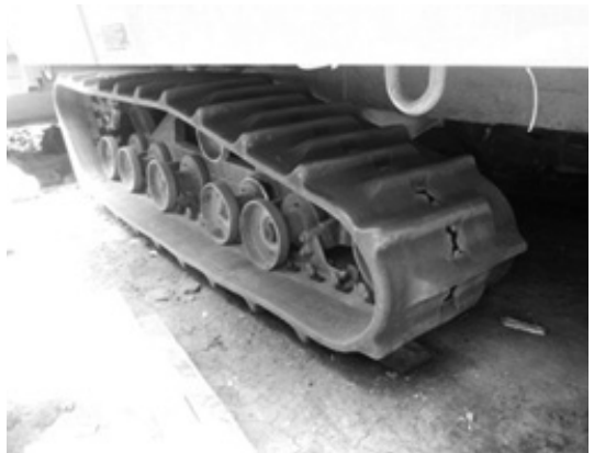
写真6 ゴム・キャタピラーに破損が見られるコンバイン。
