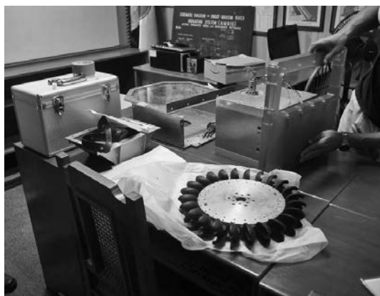
写真6 組み立て式ペルトン水車発電機
