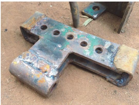
写真 15 修理を重ねたモールドボードブラウ 土壌が固く曲がることが多い
