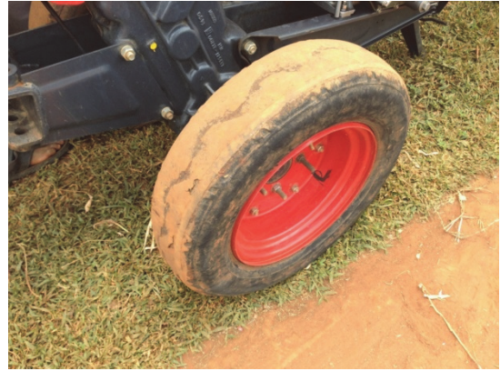
写真 16 すり減ってワイヤーが出てしまっているタイヤ スペアが手に入らない
