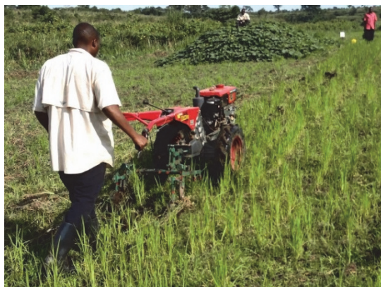
写真4 耕耘機に除草機を取付け、除草試験を行 った
