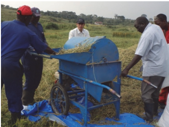
写真8 投込式脱穀機による脱穀試験
