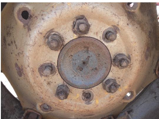
写真 33 上記写真 32 のトラクタ・ホイール ボルト が欠損している 技術的知識が不足しメンテナ ンスの基本ができない
