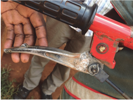
写真 13 耐久性調査の結果、クラッチレバーの破損が多く見られた 純正品の代わりにバイク部品で代用していた 木材のシャフトまで使っている
