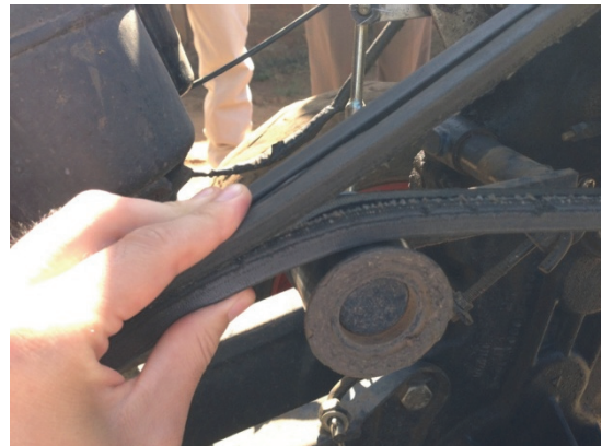
写真 17 適切に調整されていないVベルト 調整不足のベルトにより耐久性が落ちてても農家は対処できていない
