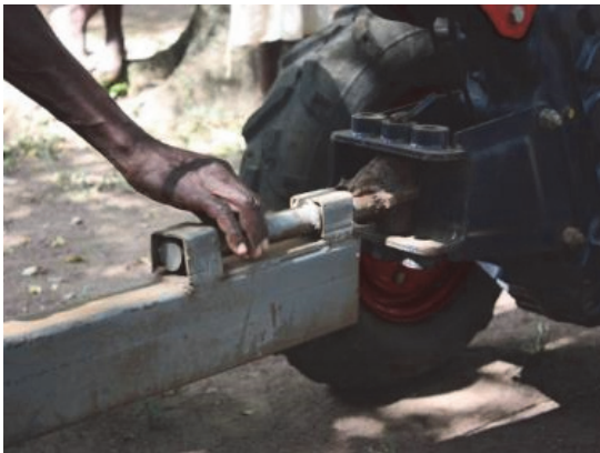
写真 14 運搬車とトレーラーを接続する牽引桿 最も破損しやすいパーツとのこと
