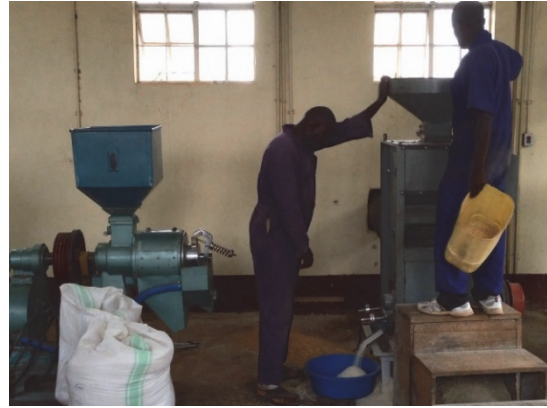
写真10 精米試験 エンゲルバーグ型(左)とミルトップ型(右)を比較した
