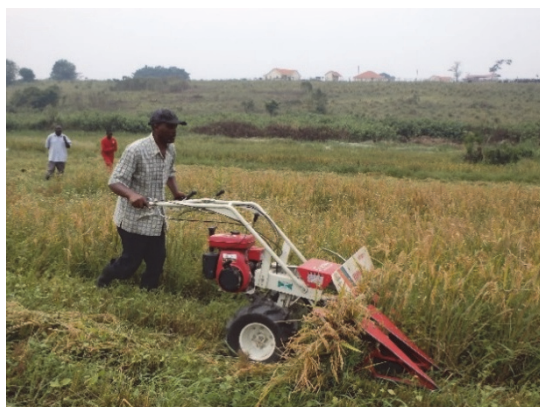
写真6 刈取機を用いた試験
