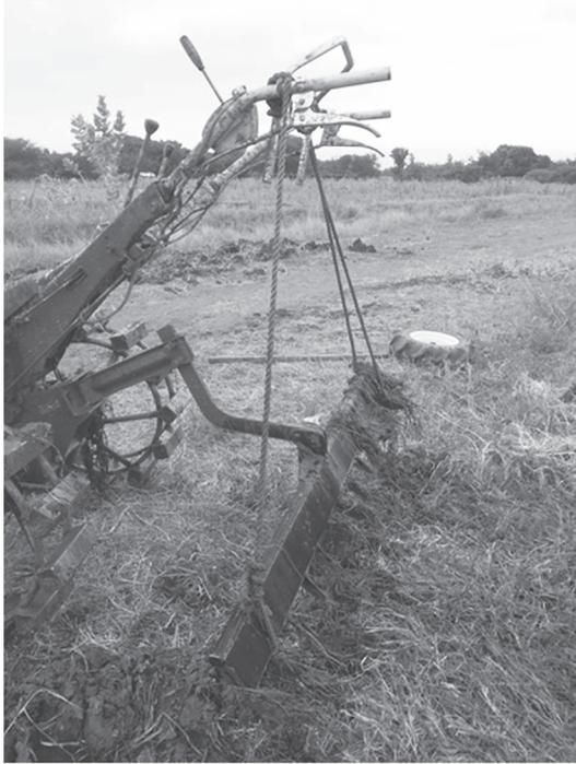
写真 42. 耕うん機が土に沈むため、レーキを紐によって固定？した状態
