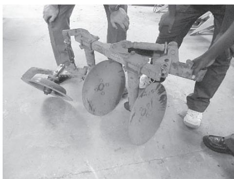
写真3 牽引式耕うん機の性能を引き出す2連ディスクプラウ。1m程度の雑草を軽々と鋤きこみ、多少の埋没物も乗り越えて耕起する。
