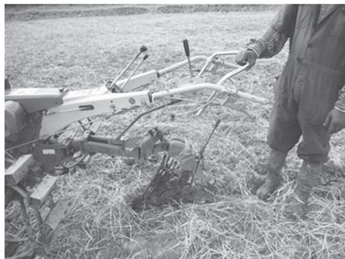
写真 23. B-6 ロータリー式耕うん機に和犁装着で
