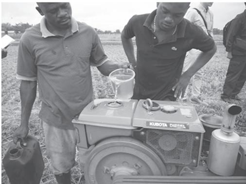
写真 32. 消費燃料測定作業
