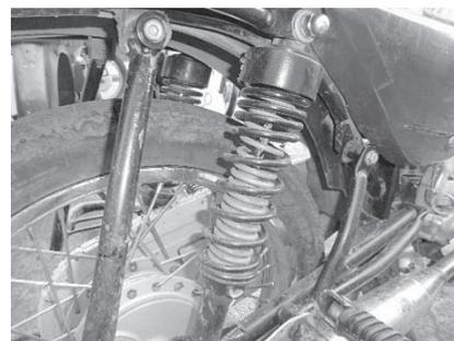
更に、左下のバイクではオイルダンパーが 2 本追加されている。さらに大きな足乗せと太いパイプが取り回されて後部の荷台をしっかりと支えている。
