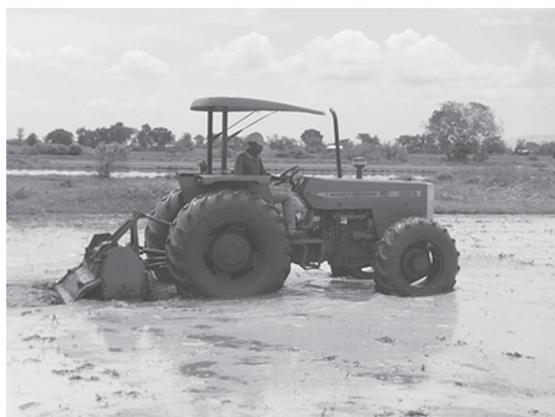
写真 70. トラクターによる湛水耕うん(うないがき)作業
