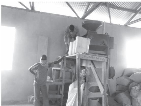
写真 89. 中国製サタケ模倣精米機 SB-50
