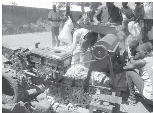
写真 II.2.7 耕うん機を動力源としてトウモロコシの脱粒を行う
