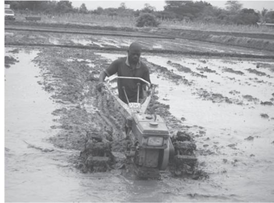
写真 43. プラウ区、レーキを用いた代掻き作業
