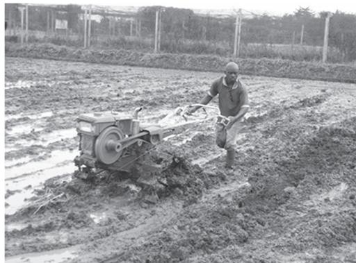
写真 35. B-6 プラウ区でのレーキを使用しての代掻き
