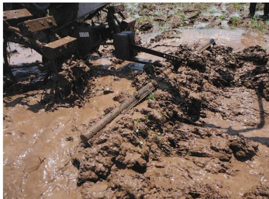
写真6 耕うん機の均平作業では専用のレーキを用いた
