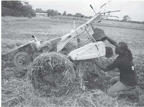
写真 30. 作業中に水を含んだ粘土質の土が、かご車輪に絡み、更に前作の稲わらが付着した様子。
