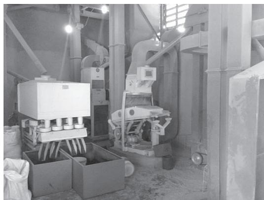
写真 II.1.104 処理能力2トン/hr の中国製ユニット
