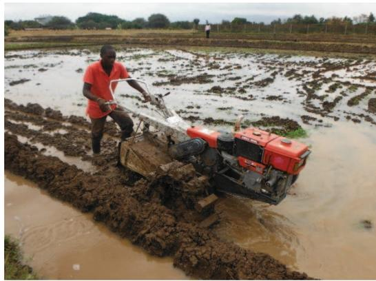
写真5 耕うん機による代掻き作業(ロータリー区)
