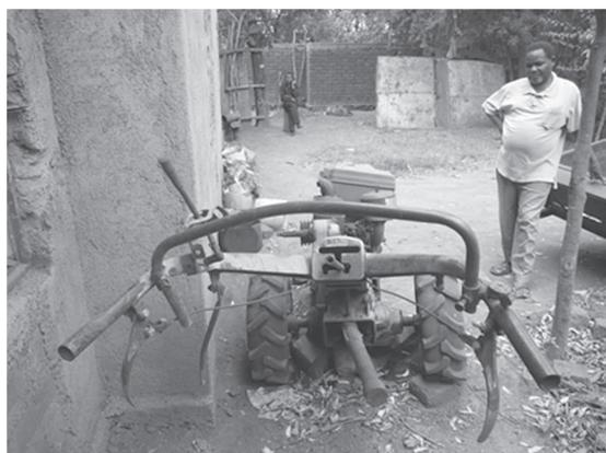
写真 80. SACCOS のローンを利用して購入した中国製耕うん機。故障し、エンジンをポンプ動力として利用
