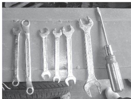
写真 II.2.11 取替られた低品質軟鉄製工具
