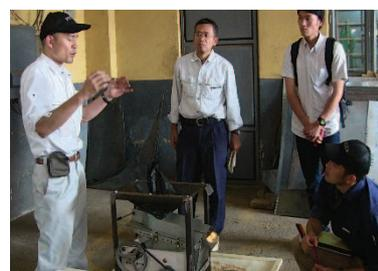
写真 III. 2. 5 外側化粧版を廃止した黒いフレームの現地仕様石抜き機（手前下）
