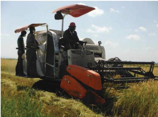
写真 14 収穫および脱穀における機械作業区では、コンバインハーベスタを選択。KUBOTA DC-70
