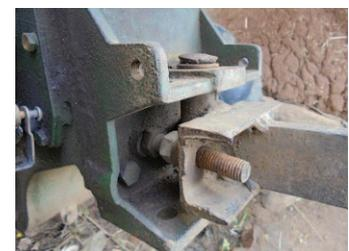
写真 III.2.4 耕うん機ヒッチ(左)に接続させるために改造されたプラウ側部分(右)
