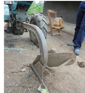
写真 III.2.2 ビームにH型鋼使用の牛耕用プラウ
