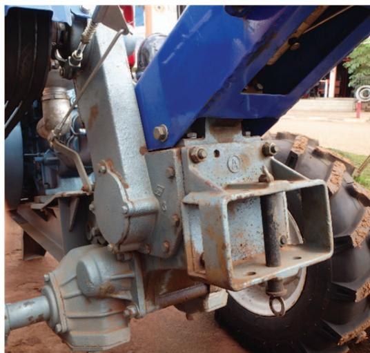
写真2 ロータリ作業機を外して、他の作業機装着用のヒッチを取付けた状態。
