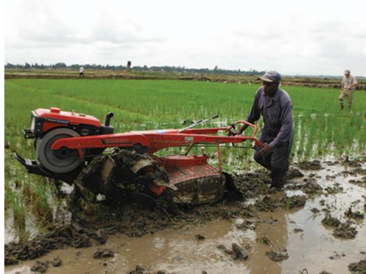
写真4 耕うん機による耕起作業。ブラックコットンソイルの圃場では、沈まないように慎重な作業が必要
