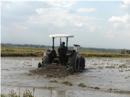
写真2 80hp 大型トラクタによる賃耕サービスが普及している。ムエアでは、粘土質の土壤に数日間湛水をしてから耕起するのが通常である
