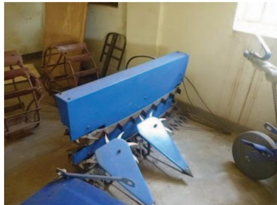
写真 36 同店舗には耕うん機の前面に装着する作業機としてリーパーも扱っていた。160 万 Ush(吉田真理子氏撮影)
