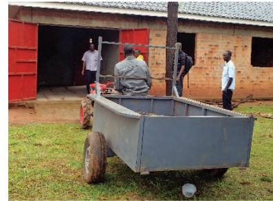
写真1 鉄製のトレーラ
