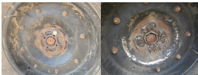
写真 III.3.2 および 3 リムの補強
