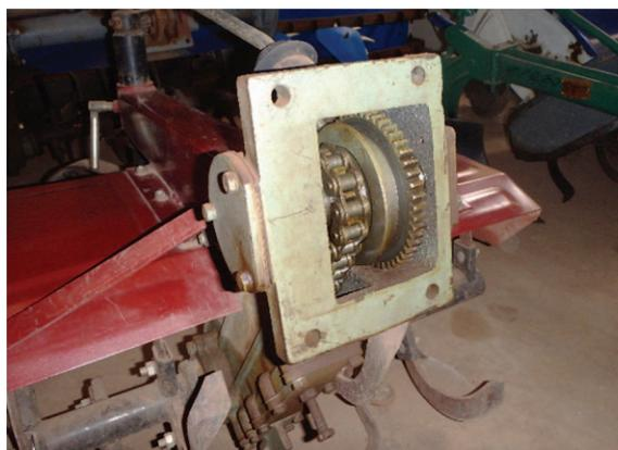
写真1 耕うん機本体から外して保管されているロータリ作業機側の動力伝達部。むき出しになっているギアの歯先だけが頼りで、ここが欠ければ交換するしか無い。
