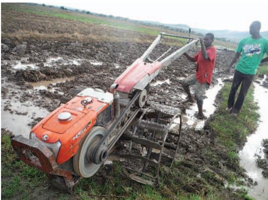
写真 39 耕起作業後の耕うん機。前面に改造されたバンパーが特徴的
