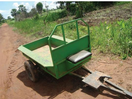
写真 33 目的地までの移動で作業機を運ぶトレーラ。カンパラの TONNET 社が製造している(Okullo Peter 氏撮影)
