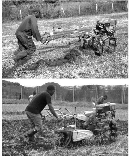
写真1 ウガンダで用いた牽引式耕うん機(上)とタンザニアで用いたロータリー着脱可能な耕うん機(下)。牽引式はロータリーが使えないが、パーツが少なくメンテナンスが容易かつ軽量で価格も安いという利点がある。また、ハンドルが長いのも特長である
