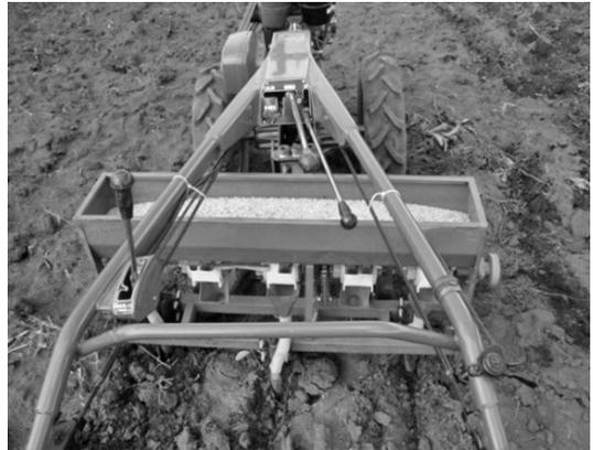
写真3 播種サービスで用いた播種機。他社製アタッチメントを工夫して活用
