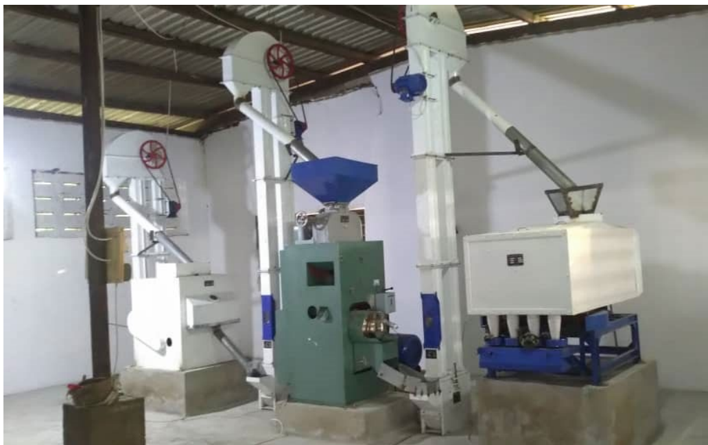
写真 16 石抜き機・精米機・グレーダーを備えた中堅規模の精米所
