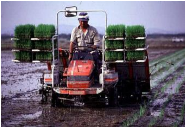
図 30-4 現代の乗用田植機による移植
