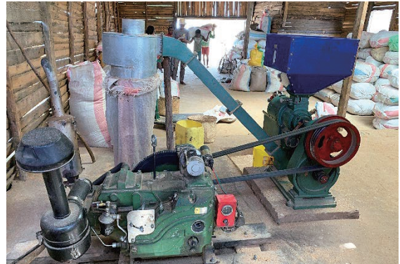
写真2 比較的新しいエンゲルバーク式精米機
