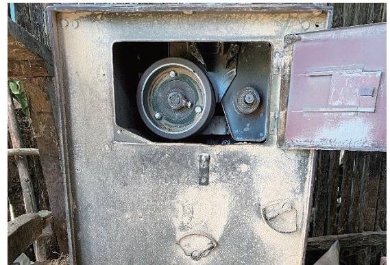
写真4 SBタイプの内部のゴムロール
