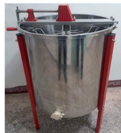
Бал ялгуур: Сархиагнаас балыг дүүгүүрдэн ялгах төхөөрөмж
