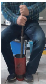
Уур нүдүүрээр нунтаглаад, шигшээд том ширхэгтэйг нь дахин нунтаглах
