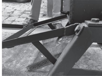
写真2 カゴを受けるフレームが左方向へ下がっているためカゴ上部からボン菓子が飛び散る
