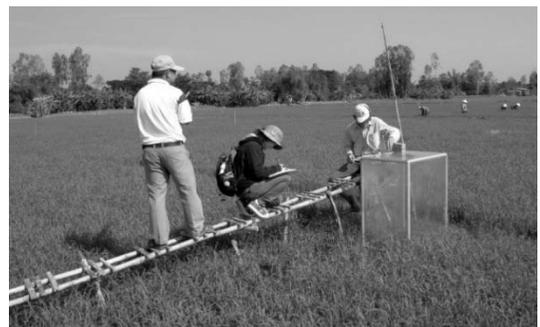
写真 チャンバー法による空気試料の採取
