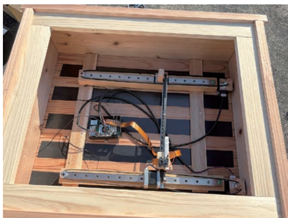
巣箱の上部に設置するスマート養蜂装置
