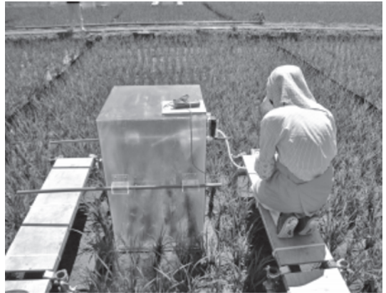
写真4 水田から発生する温室効果ガスを計測するクローズドチャンバー法
