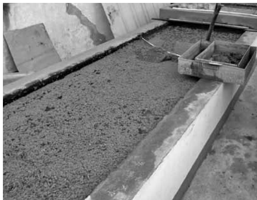
写真6 土壌洗浄用水槽
